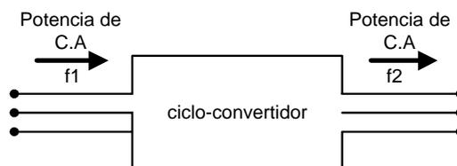
Figura 2.21. Representación de un cicloconvertidor.
